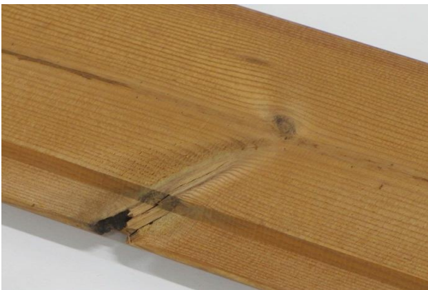
Dopuszczalne są wady, które nie są widoczne po zainstalowaniu.
