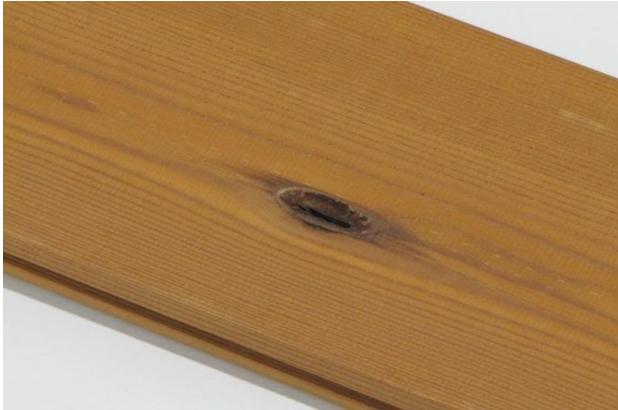
Dopuszczalne są pęcherze żywiczne.
